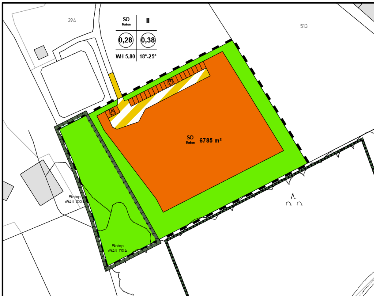
Abbildung 1: Orange dargestellt maßgebliche Grundstücksfläche zur Ermittlung von GRZ und GFZ
